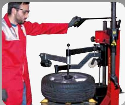
1 Funzione premi cerchio 1 *Rim clamping gripper* 1 Fonction presse-jante 1 *Felgenniederhaltefunktion* 1 Función aprieta-llanta
