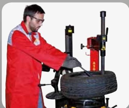
3 Smontaggio della ruota 3 *Demounting the tyre* 3 Démontage de la roue 3 *Demontage des Reifens* 3 Desmontaje de la rueda
