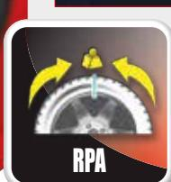
À la fin du lancement la roue est freinée et placée **automatiquement** en position d'équilibrage (RPA).
